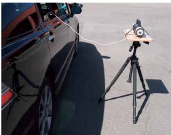
図3 車外の地表面から1mにおける線量率測定 (車体による定点測定地点)
