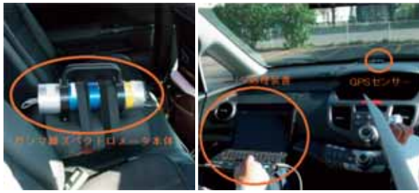
図2 車内における線量率測定
